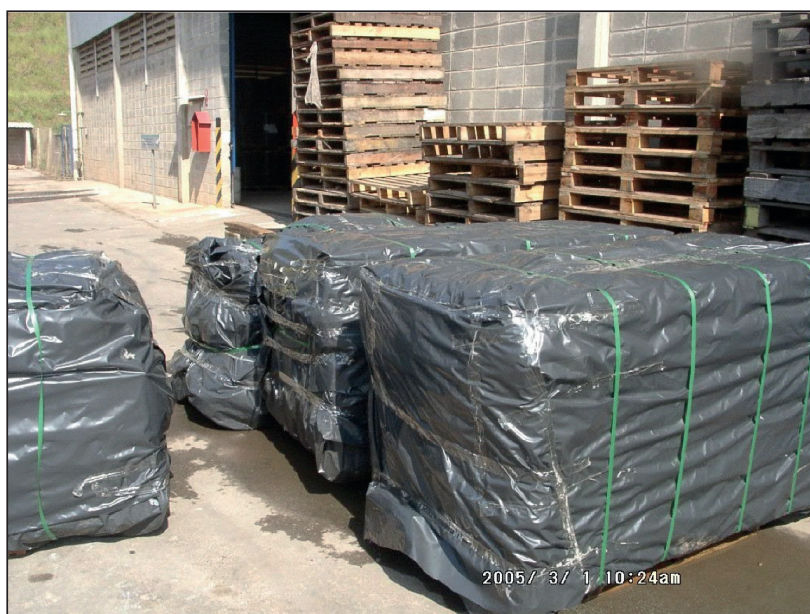
Figura 27 – Acondicionamento de peças por duas camadas de polietileno, fixadas com cintas. Fonte: Fernanda Giannasi
