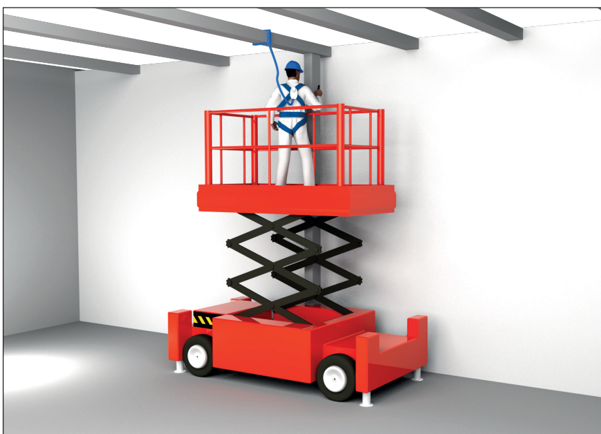
Figura 9 – Plataformas de trabalho aéreo
