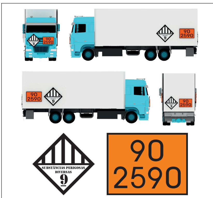
Figura 30 - Caminhão com sinalização de segurança conforme NBR 7500 para transporte de MCA e sinalização para veículos que transportam amianto
